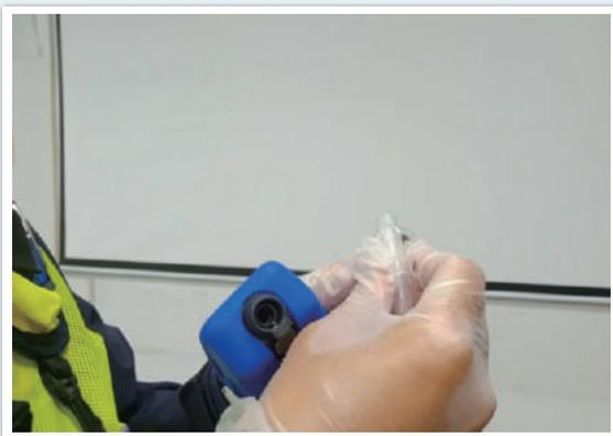
SOP3：拆除吹嘴封套
