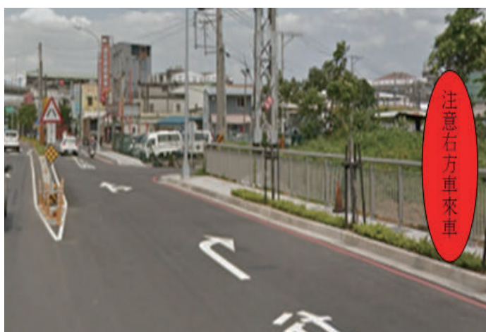
於路口設置警示牌面，提醒駕駛人注意右方來車
