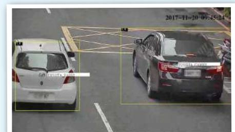
(8) 影像濃縮查詢系統：藉由去除無效資訊之畫面，迅速將影像濃縮，並視需求辨識其中移動之物體，藉此找出有意義之片段，可大幅節省員警檢視影像時間。
