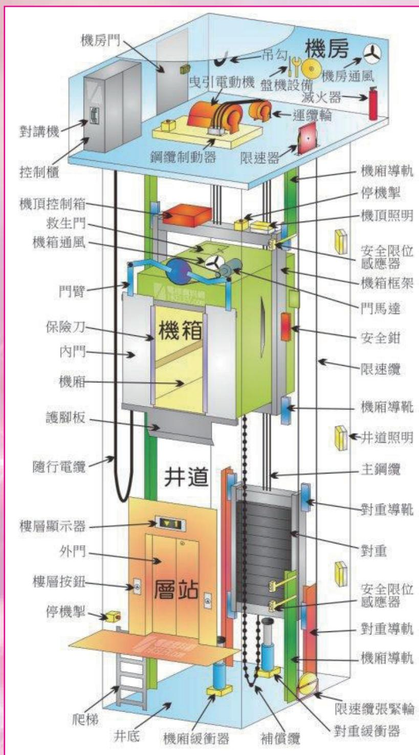
▲ 圖五、電梯升降結構與原理說明（節錄自電梯資料網站）
