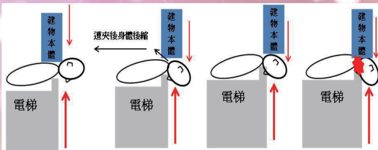
▲ 圖三、電梯事故發生經過示意圖（潘員遭電梯夾住後身體向後退，電梯持續上升後導致潘員背部、頸部、頭部傷勢。）
